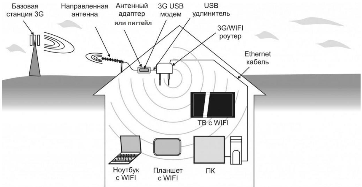
Принцип работы: в месте наилучшего приема сигнала (на крыше, на фасаде здания или за окном) устанавливается направленная антенна, ориентированная на базовую станцию оператора 3G/4G.
